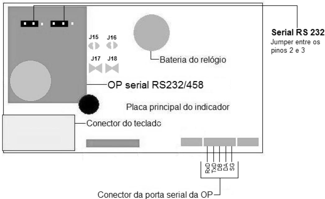
Diagrama de conexão da saída serial opcional operando em RS-485
