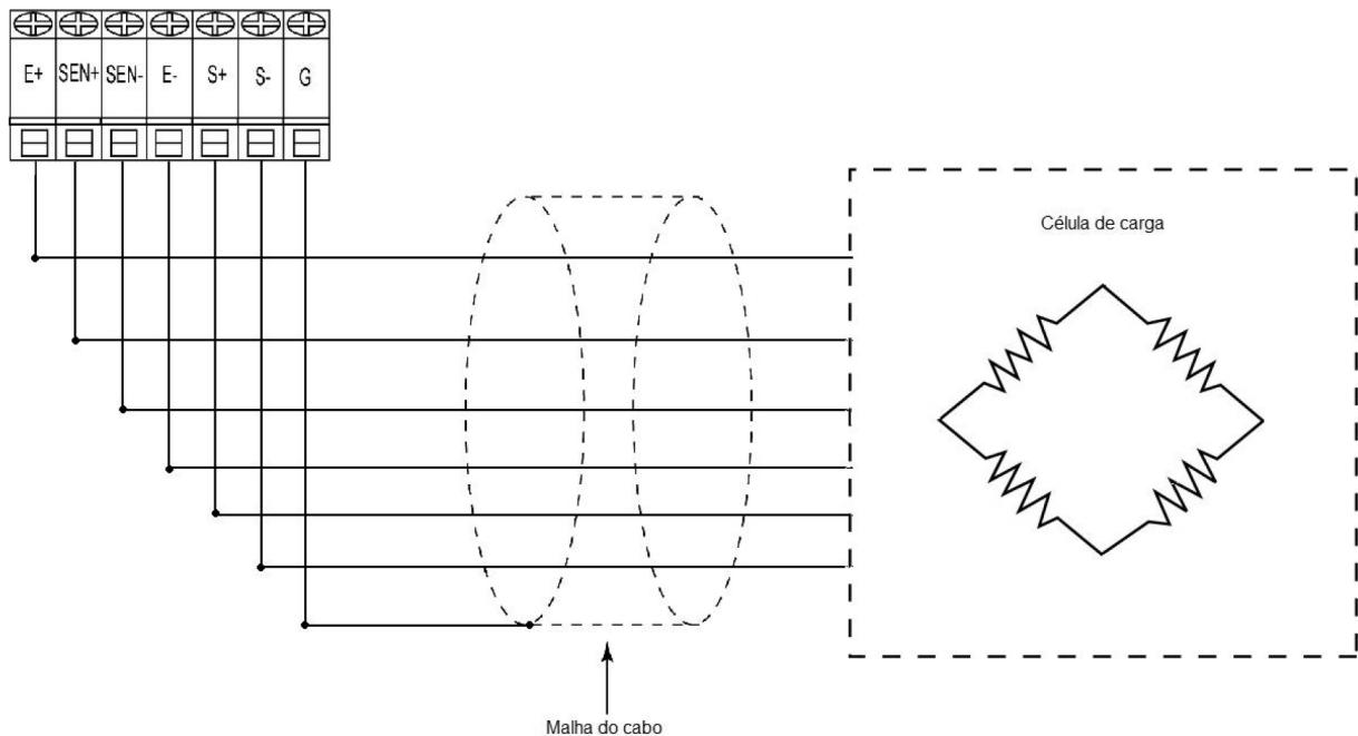
Esquema de ligação para células de carga 4 fios:
